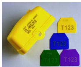
Фиг. 6 Оцветяване на повърхността на някои полимерни материали при лазерно въздействие
