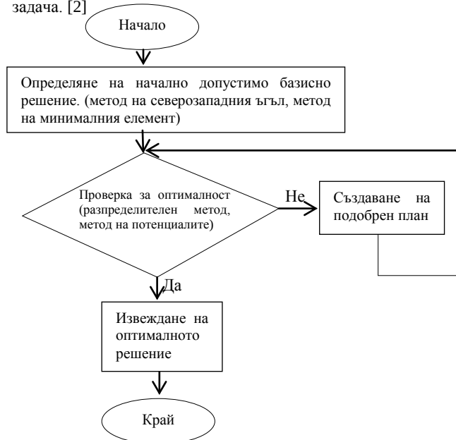
Фиг. 1 Блок – схема за решение на транспортна задача.
