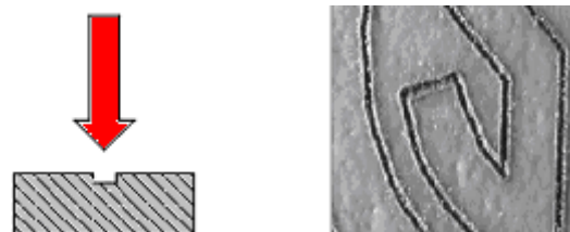
Фиг. 5 Метод на лазерно гравирание върху повърхността на материала
