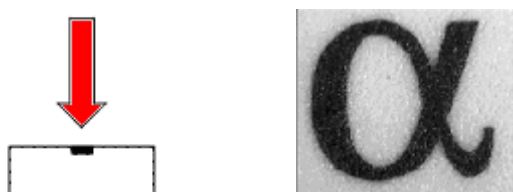
Фиг. 3 Карбонизация на повърхността на материала при лазерно въздействие
