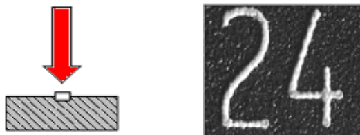
Фиг.2 Метод на маркиране чрез набъбване
