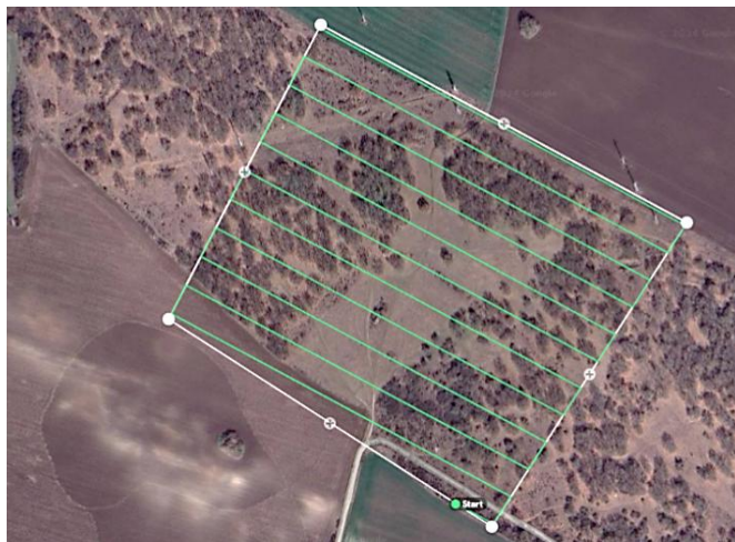
Фиг. 2 Полет на фотограметричен дрон по предварително зададен маршрут с цел аерофотографиране на зона за заемане от артилерийска батарея в района на „Беитепе“ – гр. Шумен.
