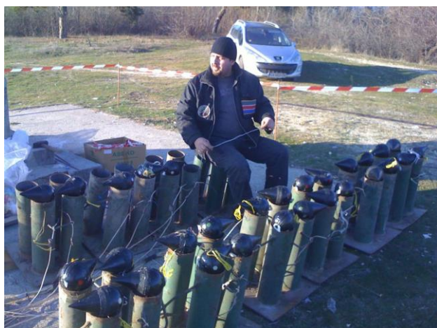
Фиг. 2 Подготовка на площадка за изстрелване на 120 mm звездни бомби.
